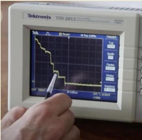
10 Jahre später zeigten Costa-Krämer und Ko-Autoren, dass sich mit sehr schwach berührenden Drähten quantisierte Leitwerte auch bei Zimmertemperatur beobachten lassen. Quantenmechanik im Wackelkontakt!
