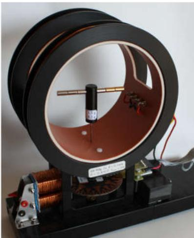
*Helmholtz-Spule mit Stabmagneten*
